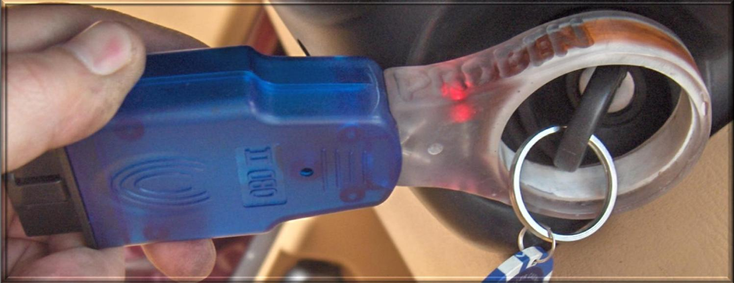
**Es una herramienta para verificación del funcionamiento de la antena lectora de transponder y el puerto OBDII**
